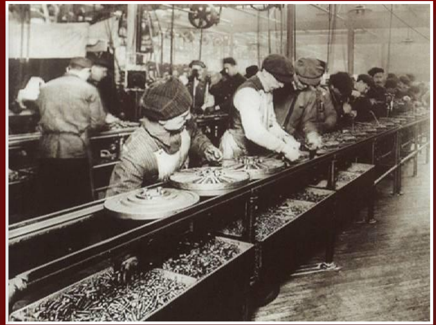
CATENA DI MONTAGGIO DI AUTOMOBILI (secondo F.W.Taylor) OFFICINE FORD , USA , 1915
