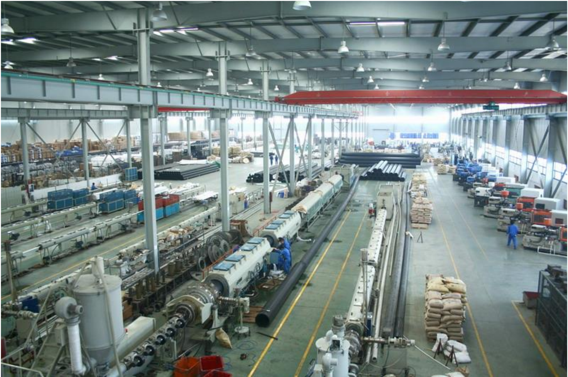
Production de tuyaux en matière plastique par extrusion
