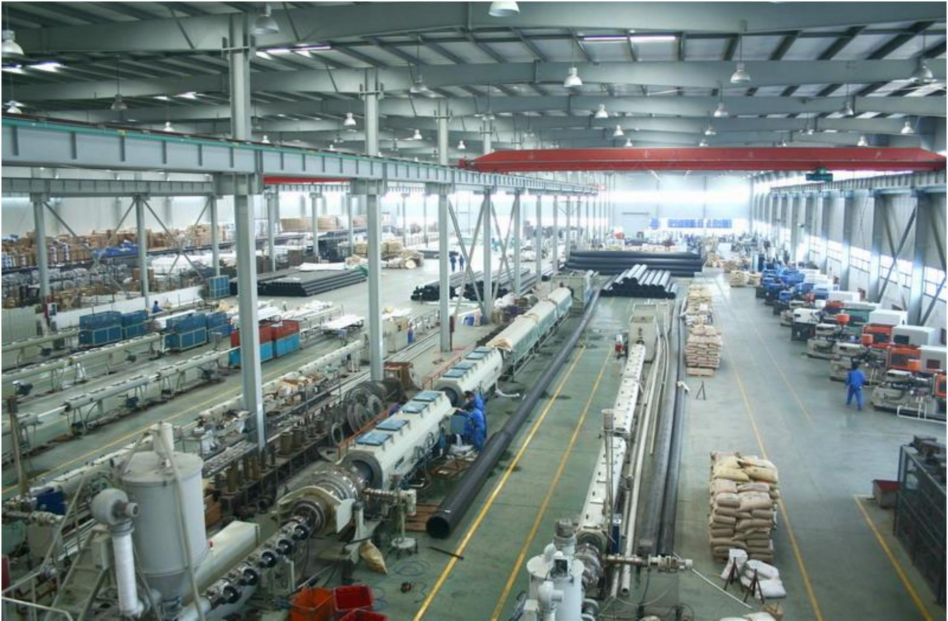
**Producción de tubos en material plástico por extrusion**
