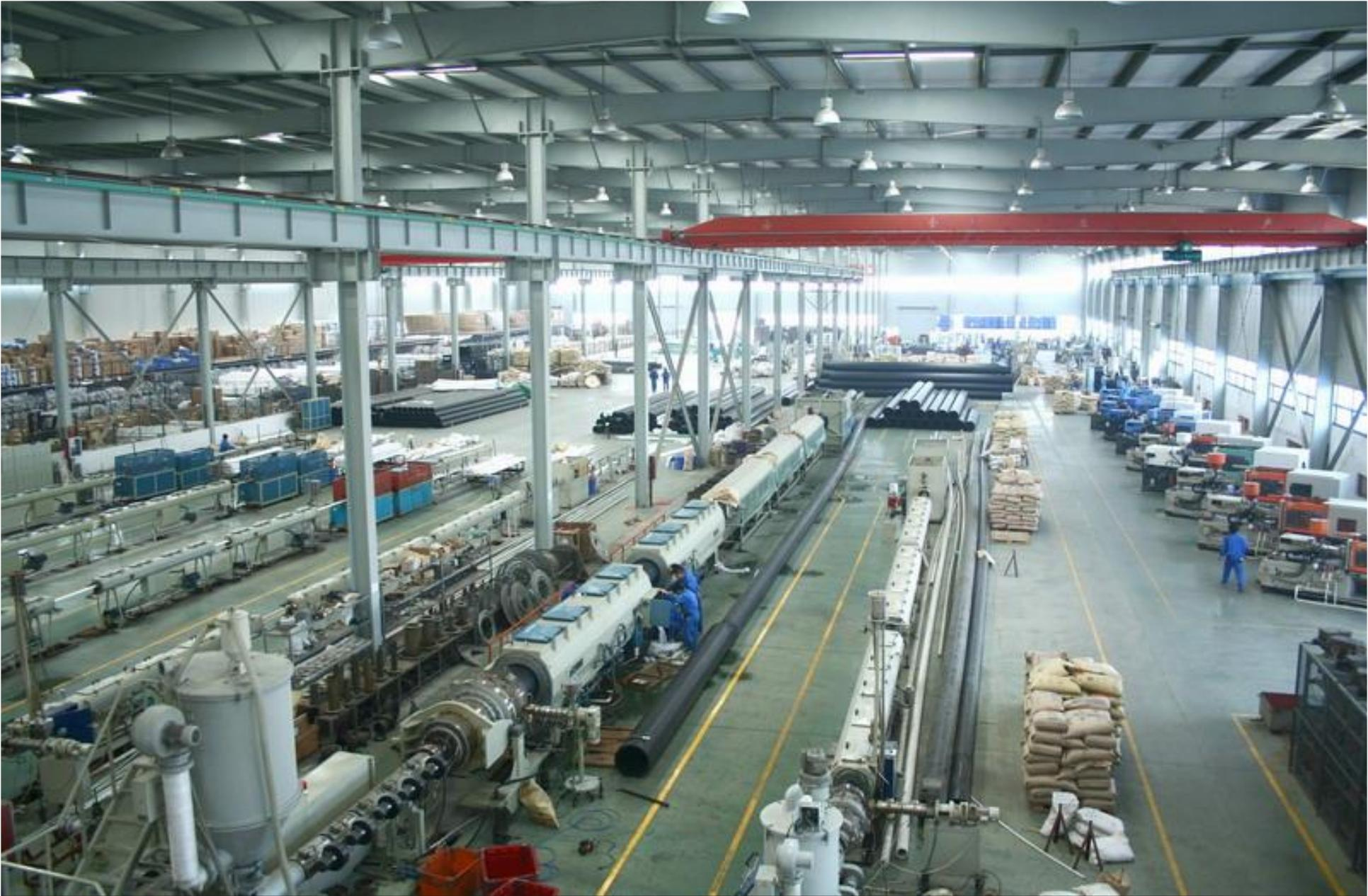
Herstellung von Kunststoffröhren durch Extrusion
